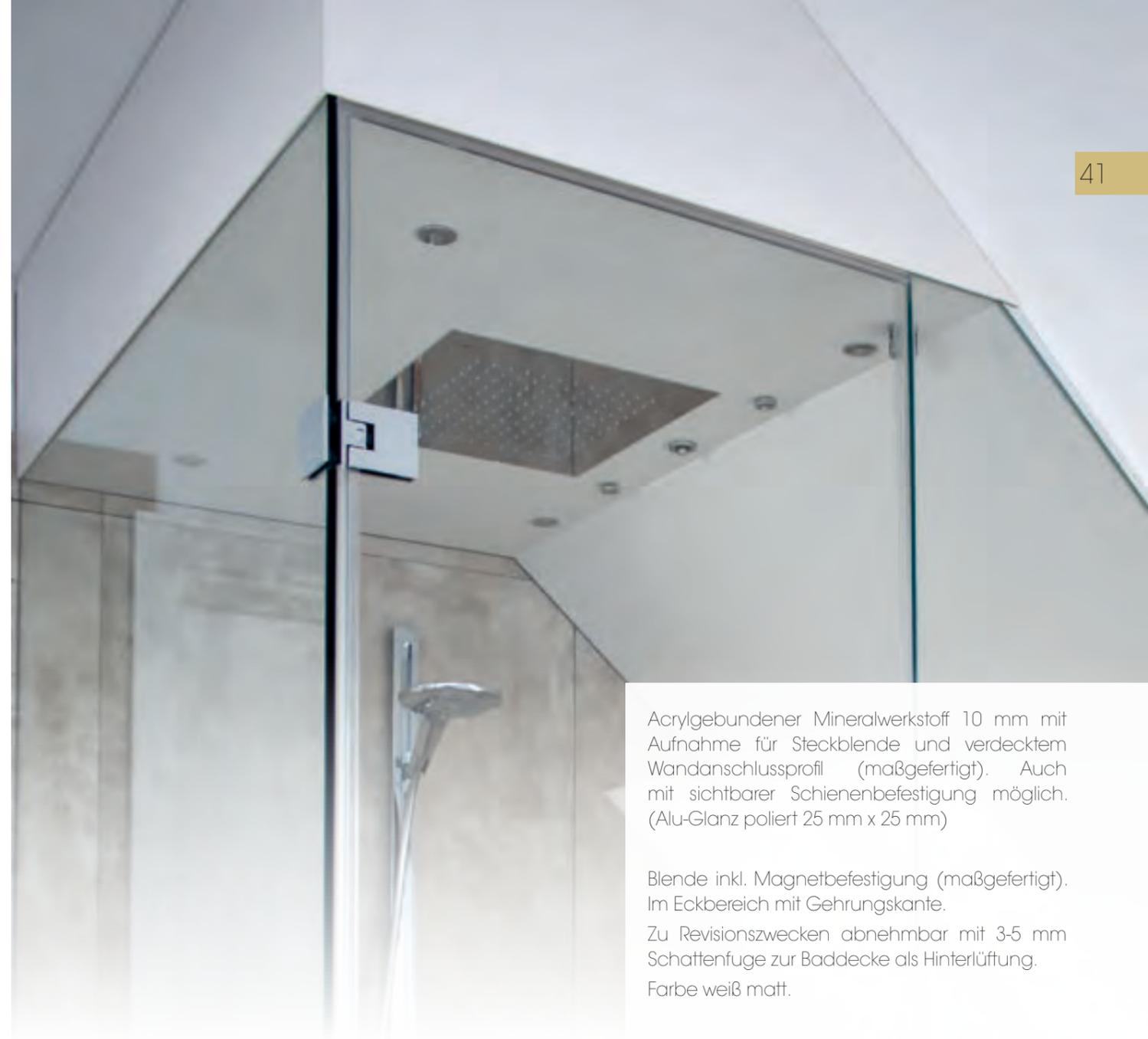
Acrylgebundener Mineralwerkstoff 10 mm mit Aufnahme für Steckblende und verdecktem Wandanschlussprofil (maßgefertigt). Auch mit sichtbarer Schienenbefestigung möglich. (Alu-Glanz poliert 25 mm x 25 mm)
